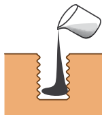
Colocação da resina sintética
