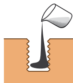
Igenfyllning med syntetisk harts
