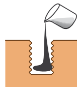
Igenfyllning med syntetisk harts
