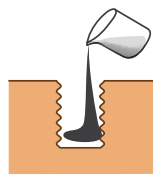
Igenfyllning med syntetisk harts
