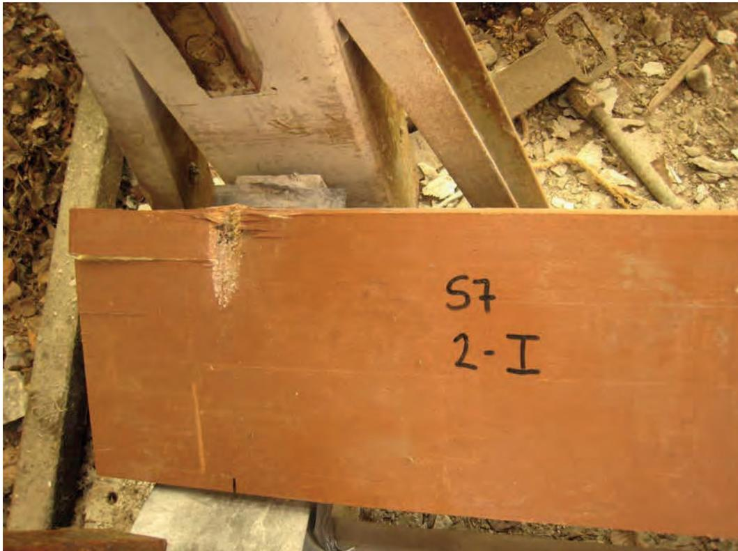
Infolge der Schlagprüfung II (außerhalb des Schienenstrangs, 15 cm vom Schwellenende) bricht entsprechend der Faserrichtung an der Stirnseite der Schwelle ein Keil aus.
