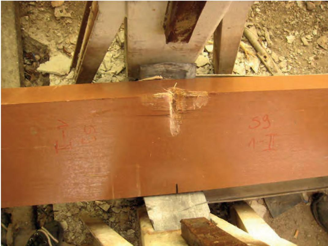
Einkerbung an Schwelle S9 nach Schlagprüfung I.
