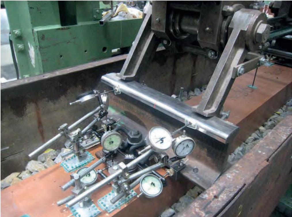
Dauerschwellversuch in Anlehnung an DIN EN 13230-3
