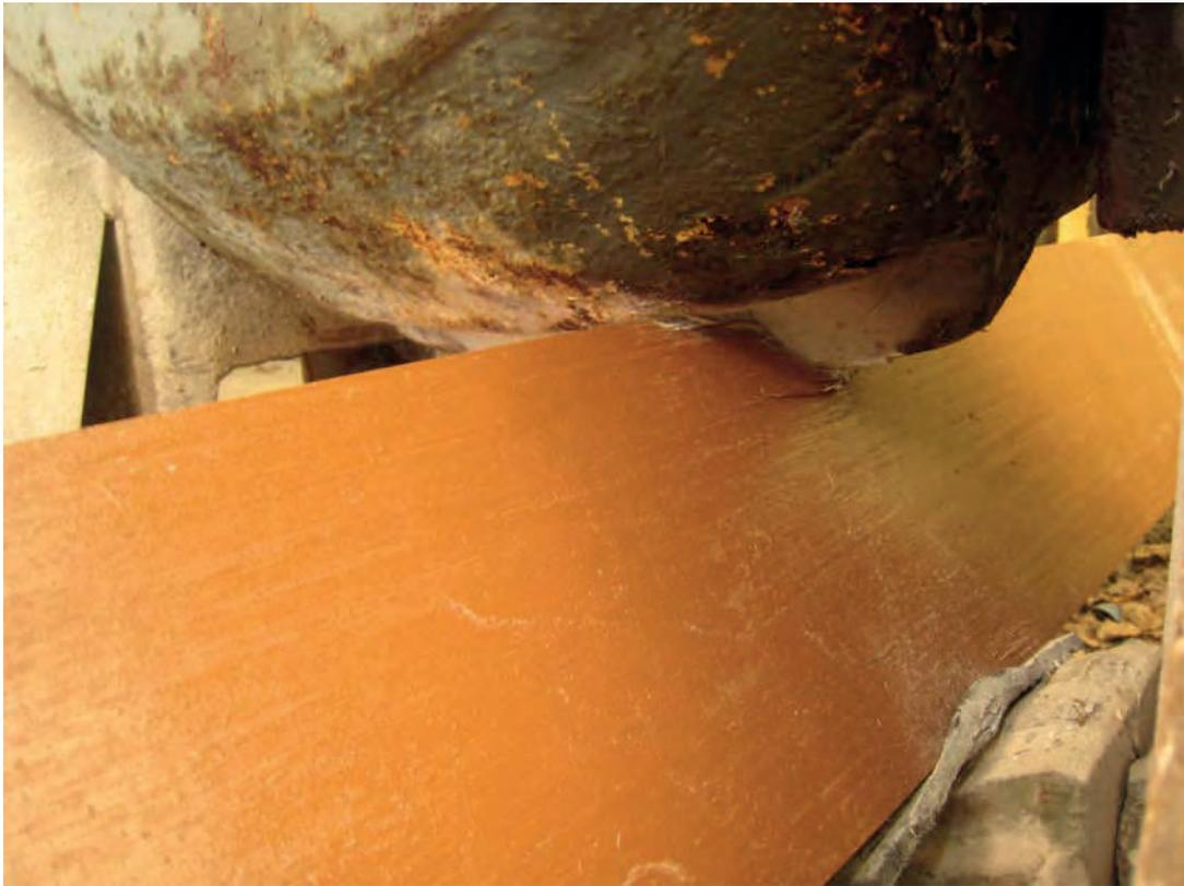
Der Fallbär mit spurkranzförmiger Schneide dringt „sauber“ in die Schwellenkante ein. Die Zerstörung der Schwelle ist lokal eng begrenzt (Breite der Schneide)
