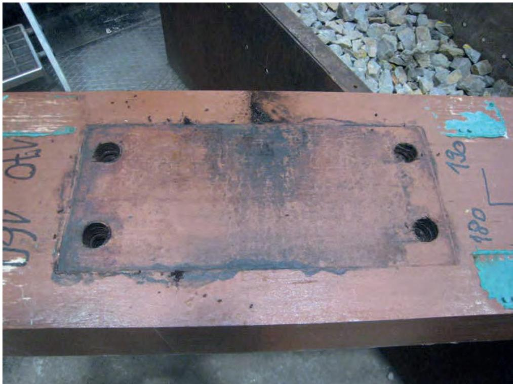
Plastische Verformungen von 0,3 – 0,7 mm an der Schwellenoberfläche nach dem Dauerschwellversuch (4,3 Mio Lastspiele)
