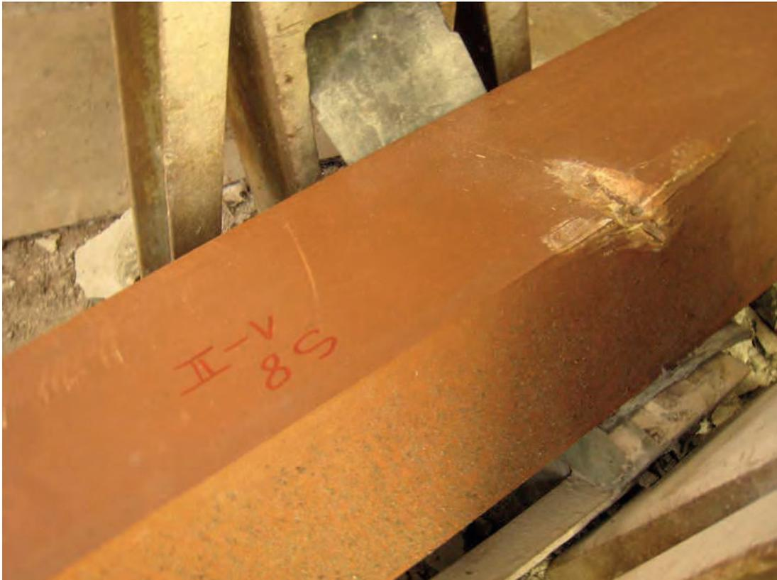
Ansicht der Schwelle S8 nach dem zweiten Schlag in Schlagprüfung I.
